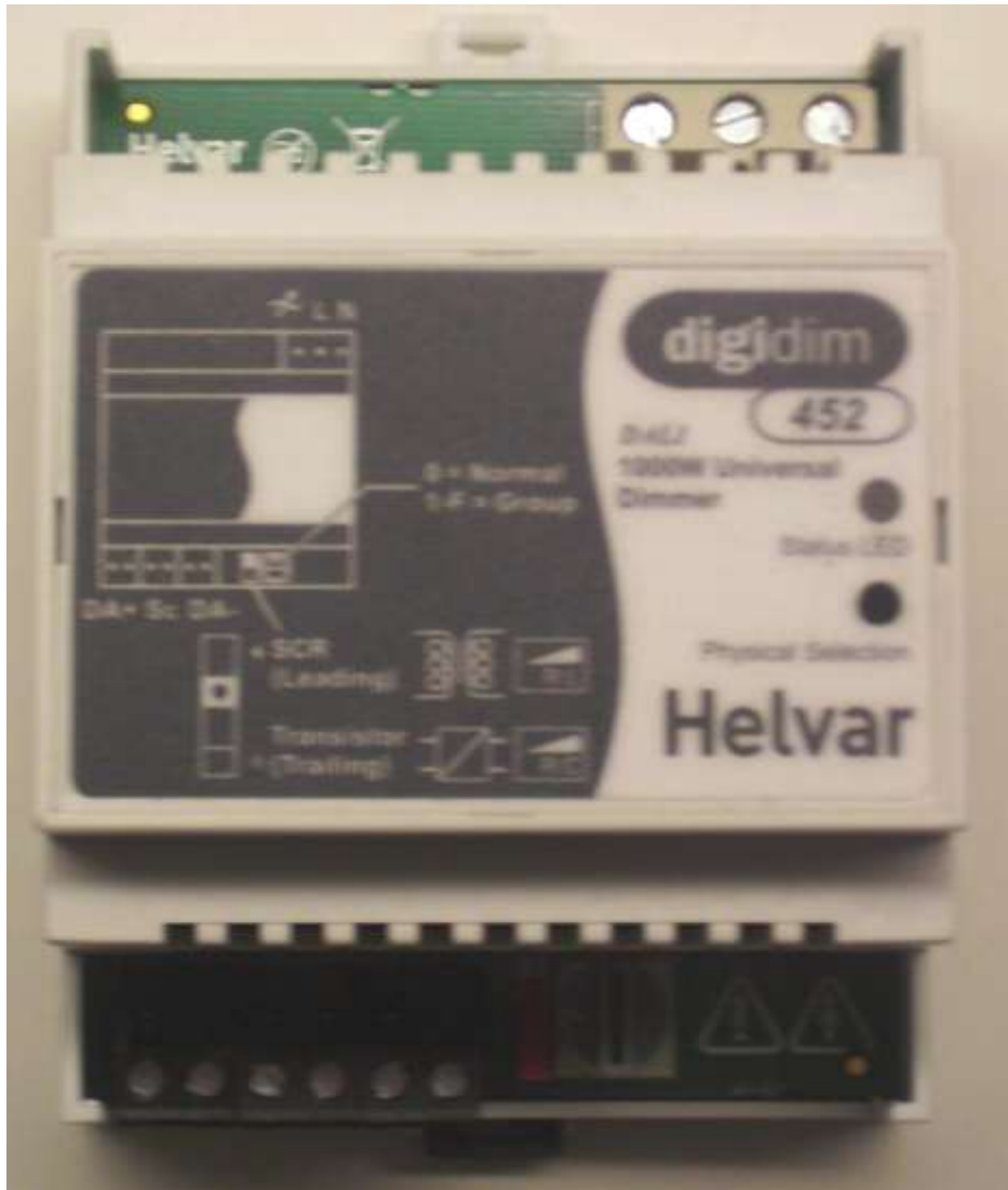
KUVA 7. Yleissäädin, jossa säädettävän lähdön liittimet ylhäällä ja DALI-väylän liittimet alhaalla (Kuva: Jarno Nurmio 2010)
