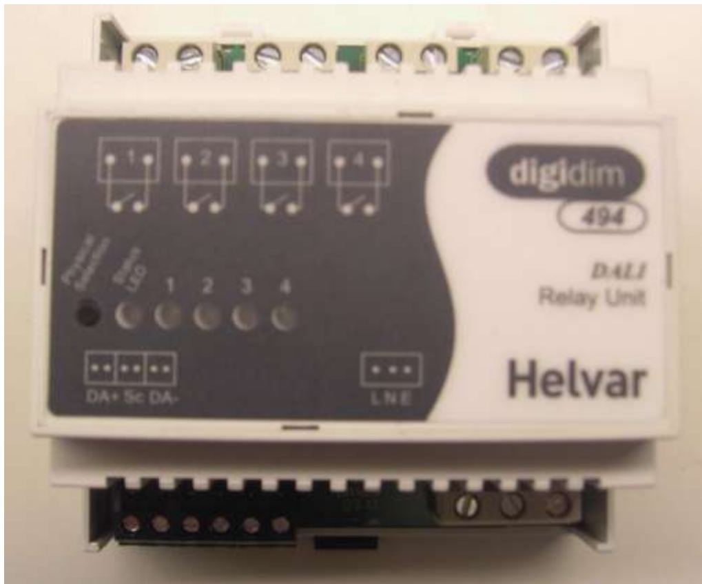
KUVA 3. Releysesikkö, jossa lähdöt yläreunassa ja DALI-väylä ja verkkojännite alareunassa (Kuva: Jarno Nurmio 2010)
