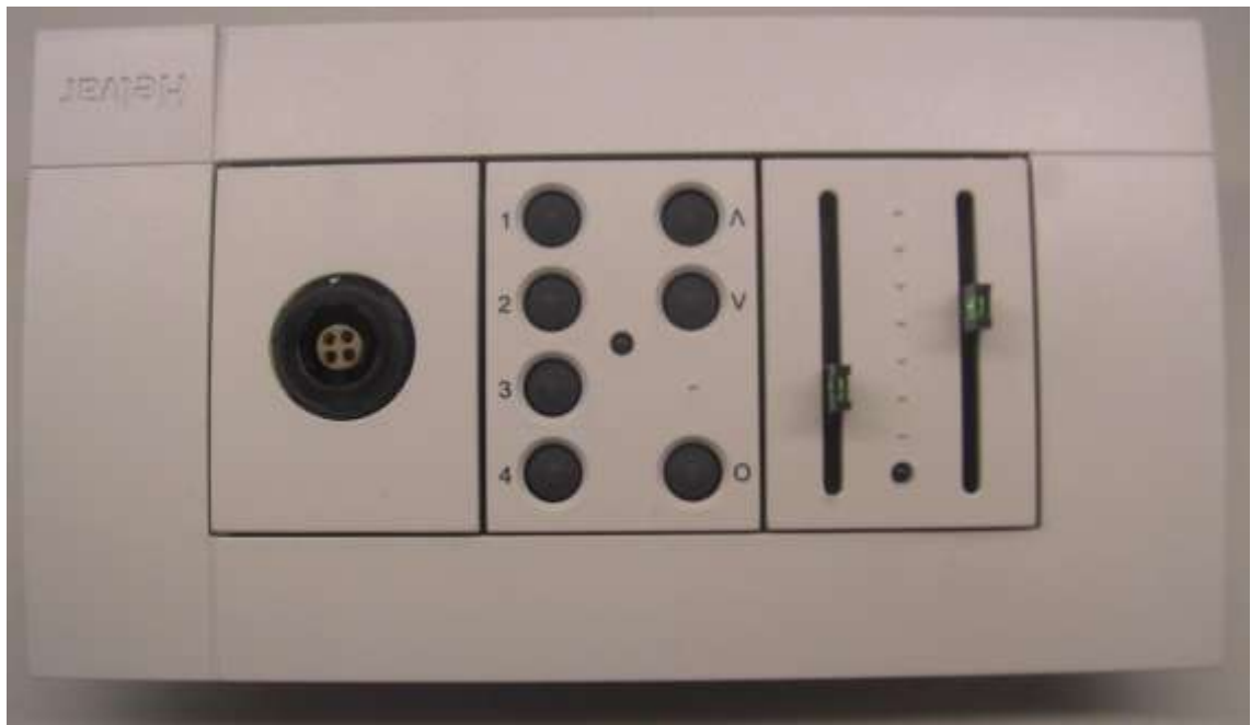
KUVA 9. Vasemmalta lueteltuna ohjelmointiliityntäpiste, 7-painike ja kaksoisliukusäänin peitelevyn alle asennettuna edestäpäin kuvattuna (Kuva: Jarno Nurmio 2010)
