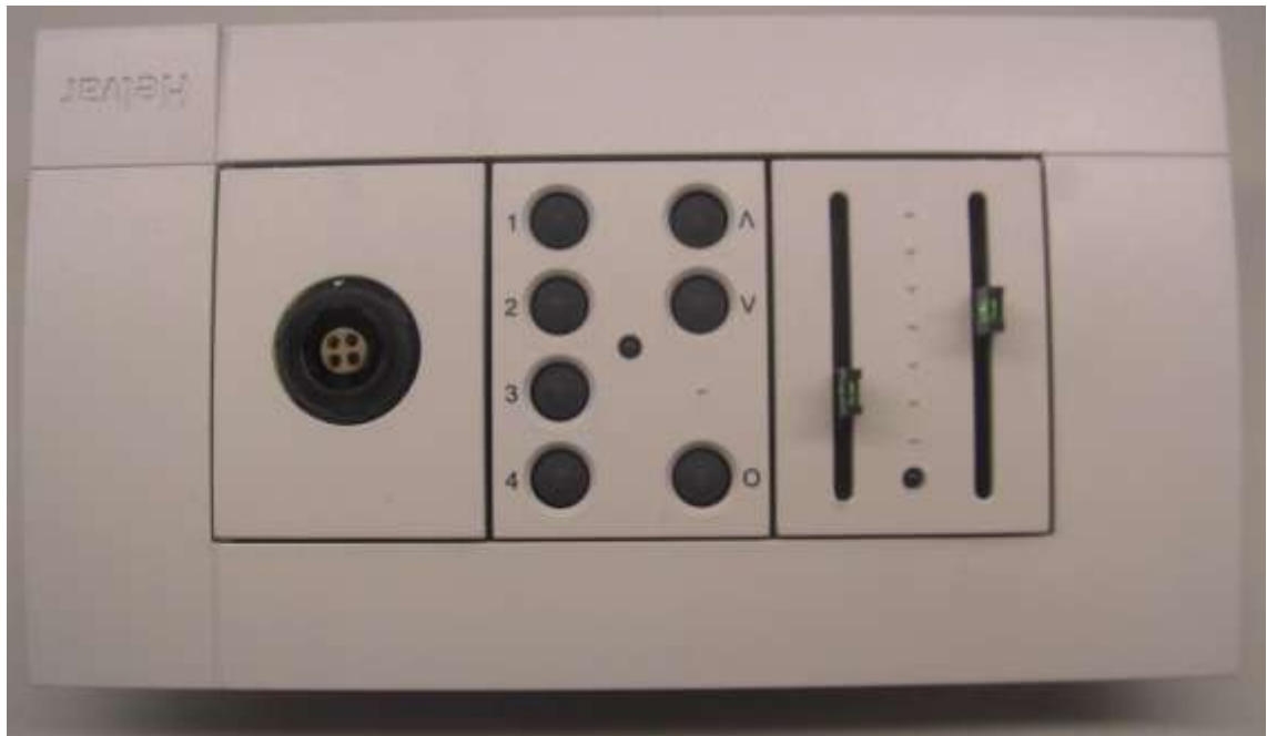
KUVA 12. Vasemmalta lueteltuna ohjelmointiliityntäpiste, 7-painike ja kaksoisliukusäädin peitelevyn alle asennettuna edestäpäin kuvattuna (Kuva: Jarno Nurmio 2010)
