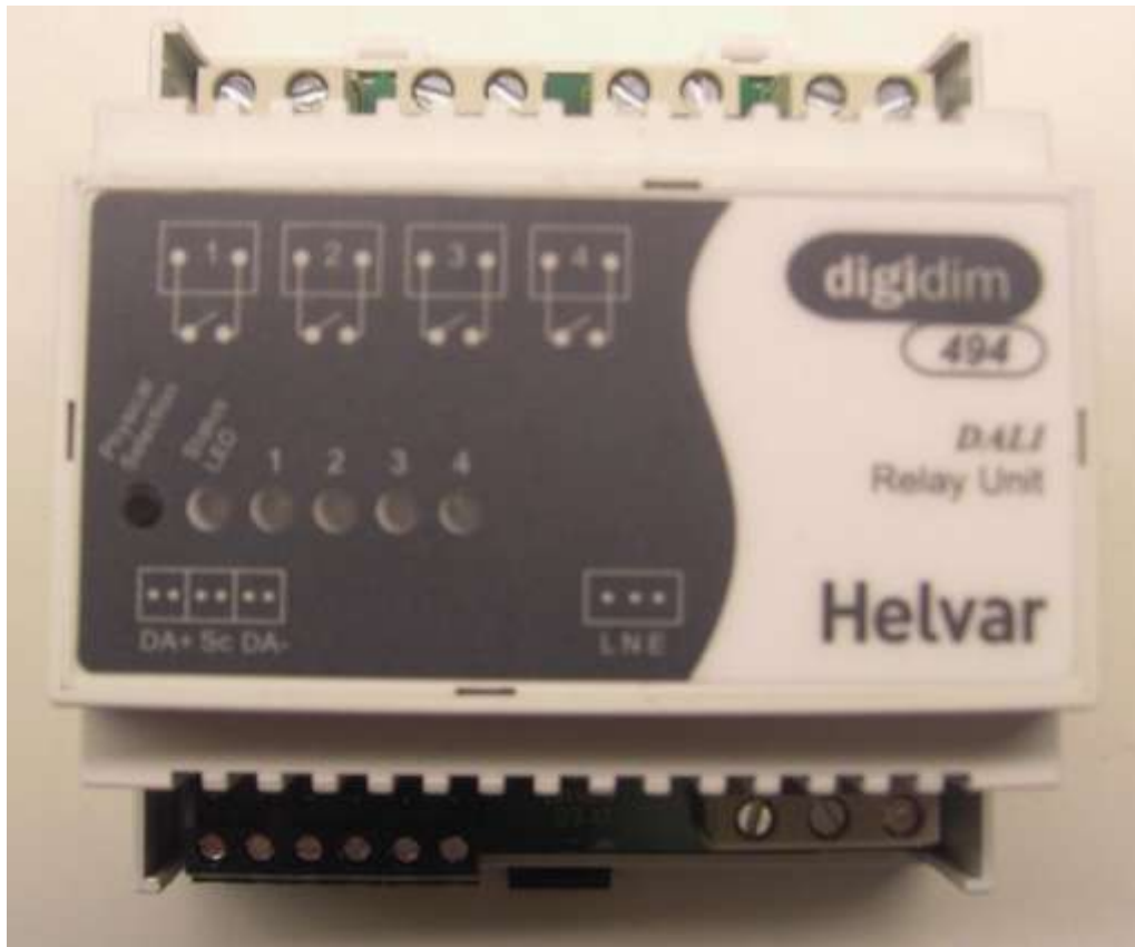
KUVA 6. Releysesikkö, jossa lähdöt yläreunassa ja DALI-väylä ja verkkojännite alareunassa (Kuva: Jarno Nurmio 2010)
