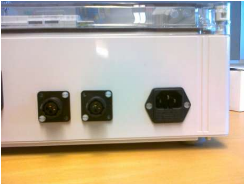
KUVA 4. Neljännapaiset CPC-laiteliittimet vasemmalla sekä virtaliitin (Kuva: Jarno Nurmio 2011)
