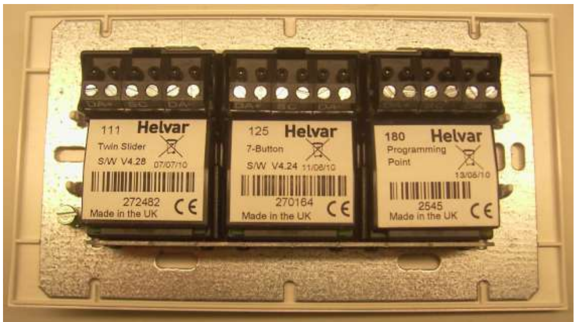
KUVA 10. Vasemmalta lueteltuna kaksoisliukusäänin, 7-painike ja ohjelmointiliityntäpiste peitelevyn alle asennettuna takaapäin kuvattuna (Kuva: Jarno Nurmio 2010)
