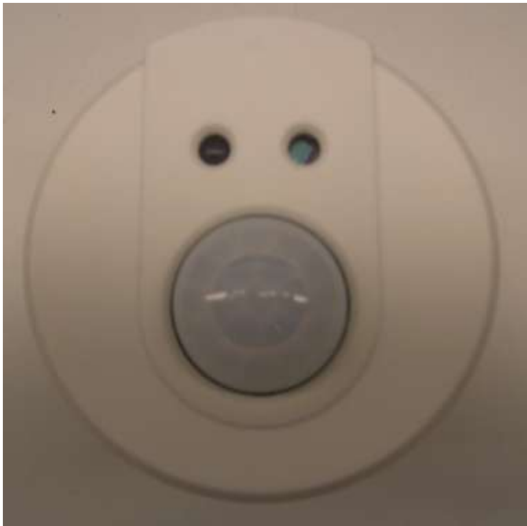
KUVA 7. Multisensori etupuolelta kuvattuna (Kuva: Jarno Nurmio 2010)
