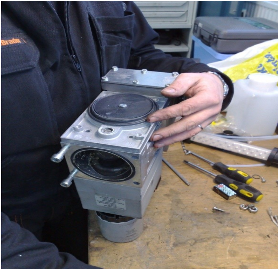
KUVIO 22. Etualalla sijaitsee maakaasupolttimen sulkuventtiili ja takana paineentasausventtiili. Kuvassa on käden kohdalla paineentasausventtiilin paineensäätökälvö.
