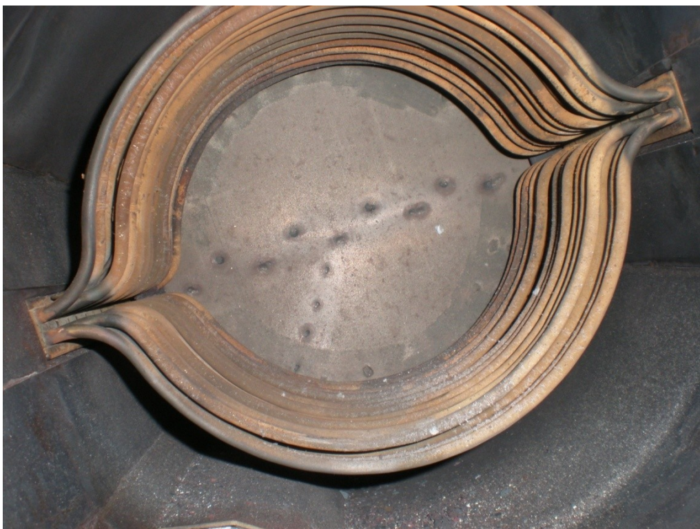
KUVIO 30. Stirling- moottorin lämmönsiirtopinta kokeen jälkeen
