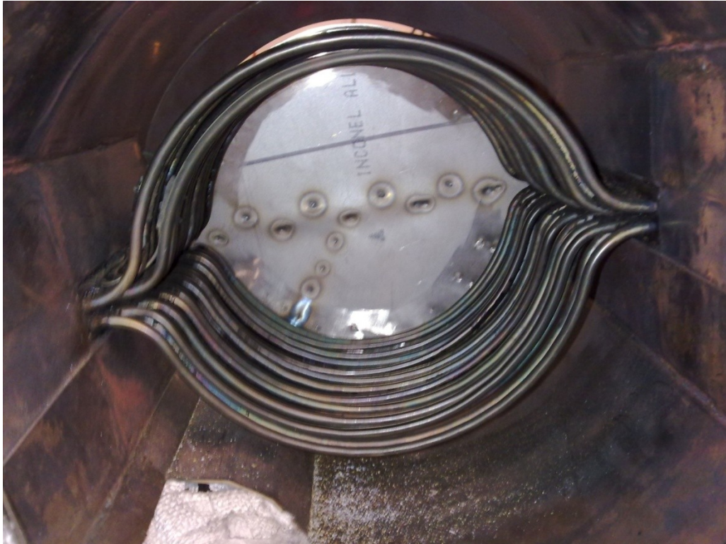
KUVIO 29. Stirling- moottorin lämmönsiirtopinta ennen koetta
