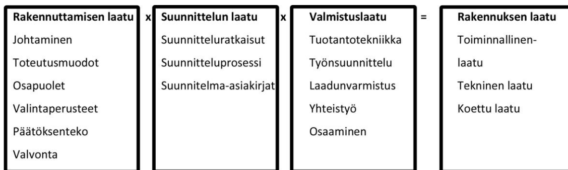
Kuva 6. Rakennuksen laadun määrittäminen Valtioneuvoston selvitys ja tutkimustoiminnan mukaan. Kuva: Valtioneuvoston selvitys- ja tutkimustoiminta (14 s.14)
