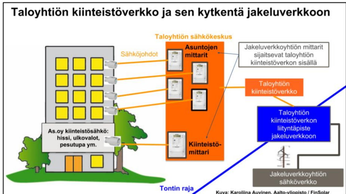
KUVA 1. Taloyhtiön kiinteistöverkko ja sähkömittarit. (Auvinen, K. ym. 2020)
