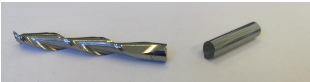
Kuva 7. Terä katkesi vaativan aukotuksen aikana.
