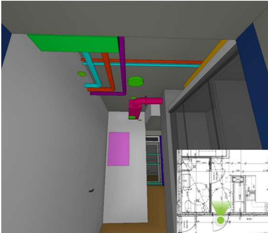
KUVA 2. Tekninen visualisointi asunnon eteisen alas lasketun katon yläpuolella. (Build.dalux 2020)
