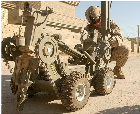
Figur 1. Telemanövrerad robot för militärt bruk. /41/
