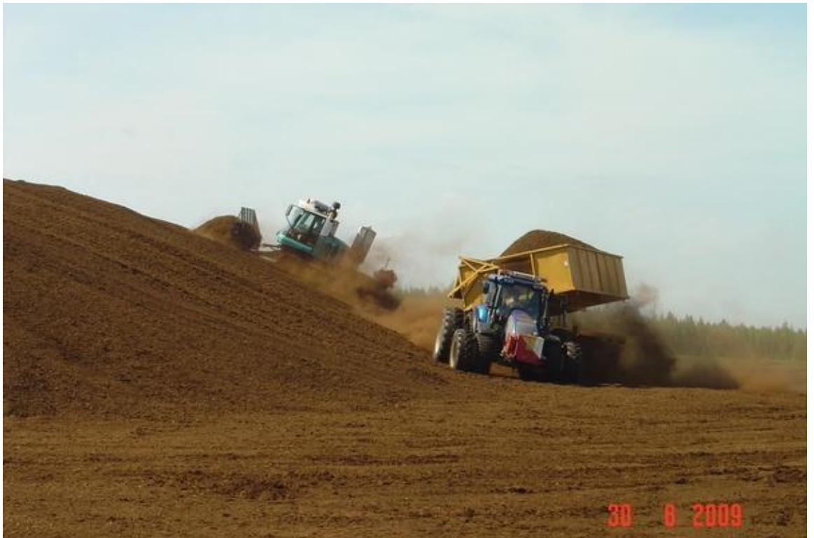
Kuva 7 Turve lasketaan auman juurelle, ja pusketaan ylös aumaan puskutraktorilla. Kuva Enni Karvinen 2010.
