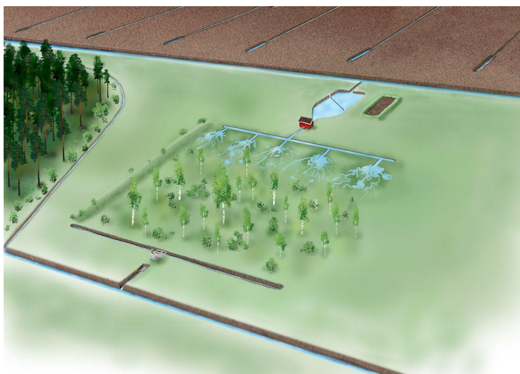
Kuva 1 Periaatekuva turvetuotantoalueen vesienkäsittely rakenteista. Vapo Oy. Lupa kuvan käyttöön saatu.
