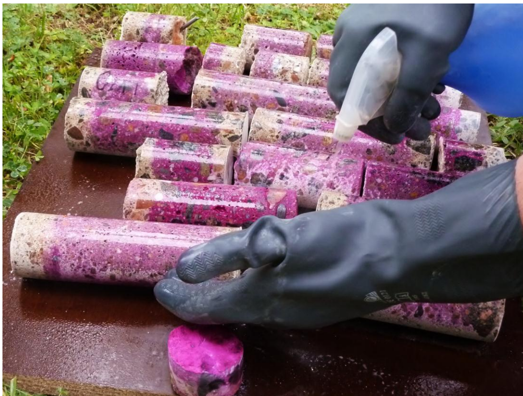
KUVIO 7. Näyteliieriöiden suihkutusta fenoliftaleiiniliuoksella
