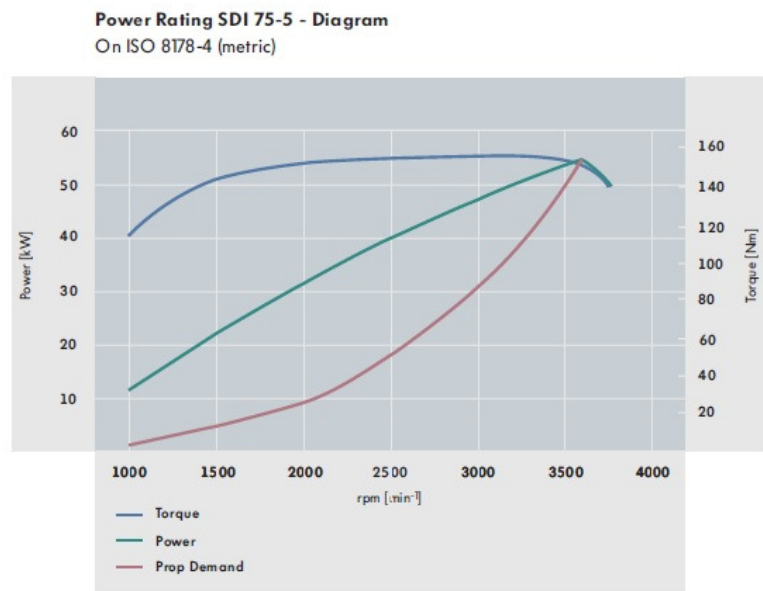
Kuva 22: Volkswagen Marine SDI 75-5:n teho-kierros-vääntö-diagrammi (Volkswagen Marine)
