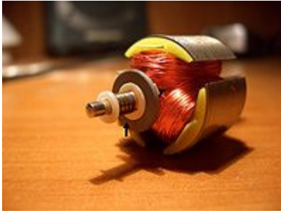
Kuva 4: Kuvassa on roottori käämeineen, akselilla käämityksen edessä on roottorin kommutaattori.
