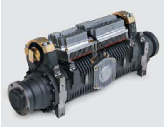
Kuva 28: Kuvassa on Linden kompakti vetoakseli (Electric Counterbalance Trucks. Linde)
