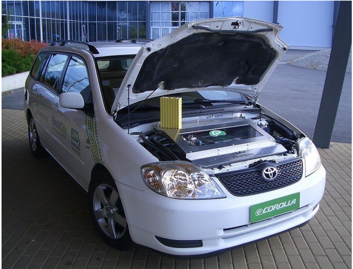
Kuva 22: Suomalaisen sähköautoyhteisön sähköautoksi muutattama Toyota Corolla wagon (eCorolla-verkkojulkaisu)
