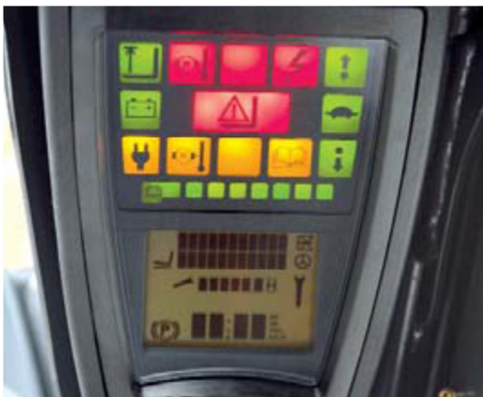
Kuva 29: Energianhallinnan ohjausyksikkö (Electric Counterbalance Trucks. Linde)
