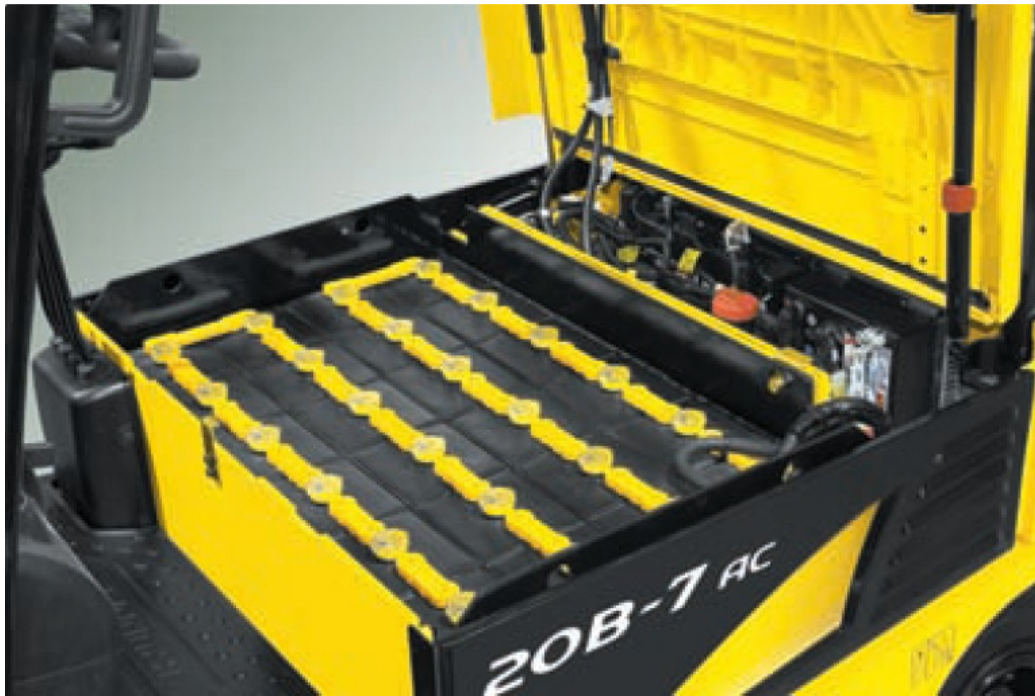
Kuva 33: Istuimen alla oleva akkujärjestelmä (Hyundai Heavy Industries Co.)
