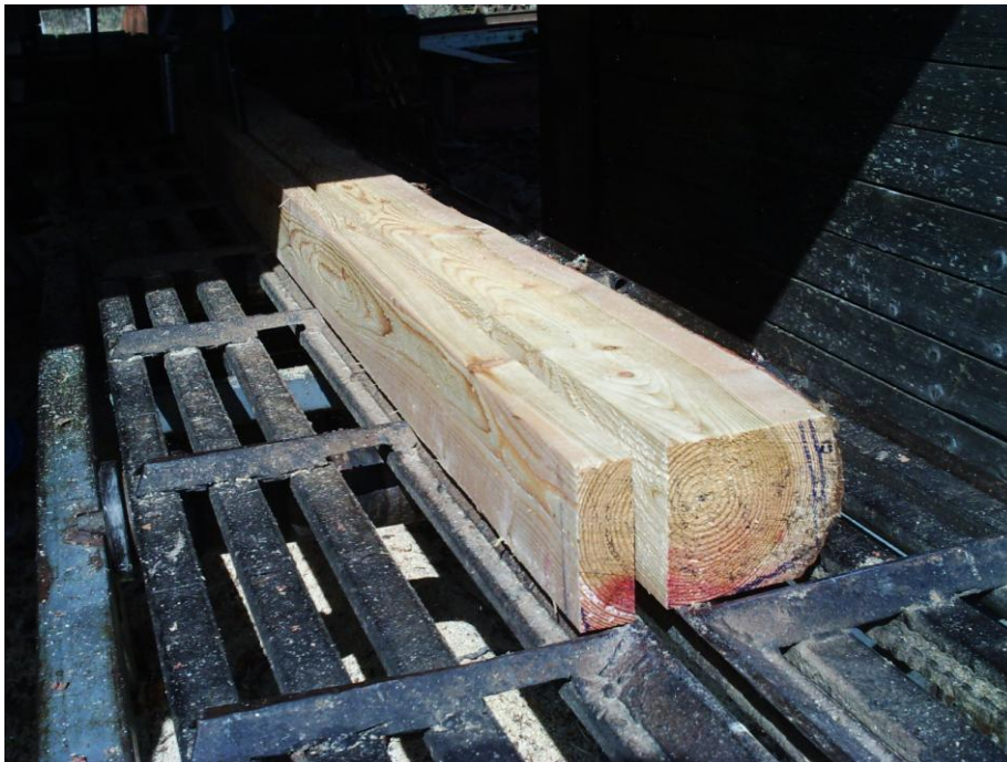
Kuva 2. Lehtikuusesta sahattu puutavara 32x100 mm (Kuva: Janne Poikala)
