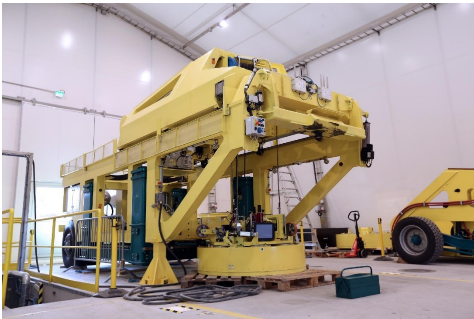
Kuva 3. Puskurin asennusjärjestelmän prototyypilaite (Posivan www-sivut 2021)
