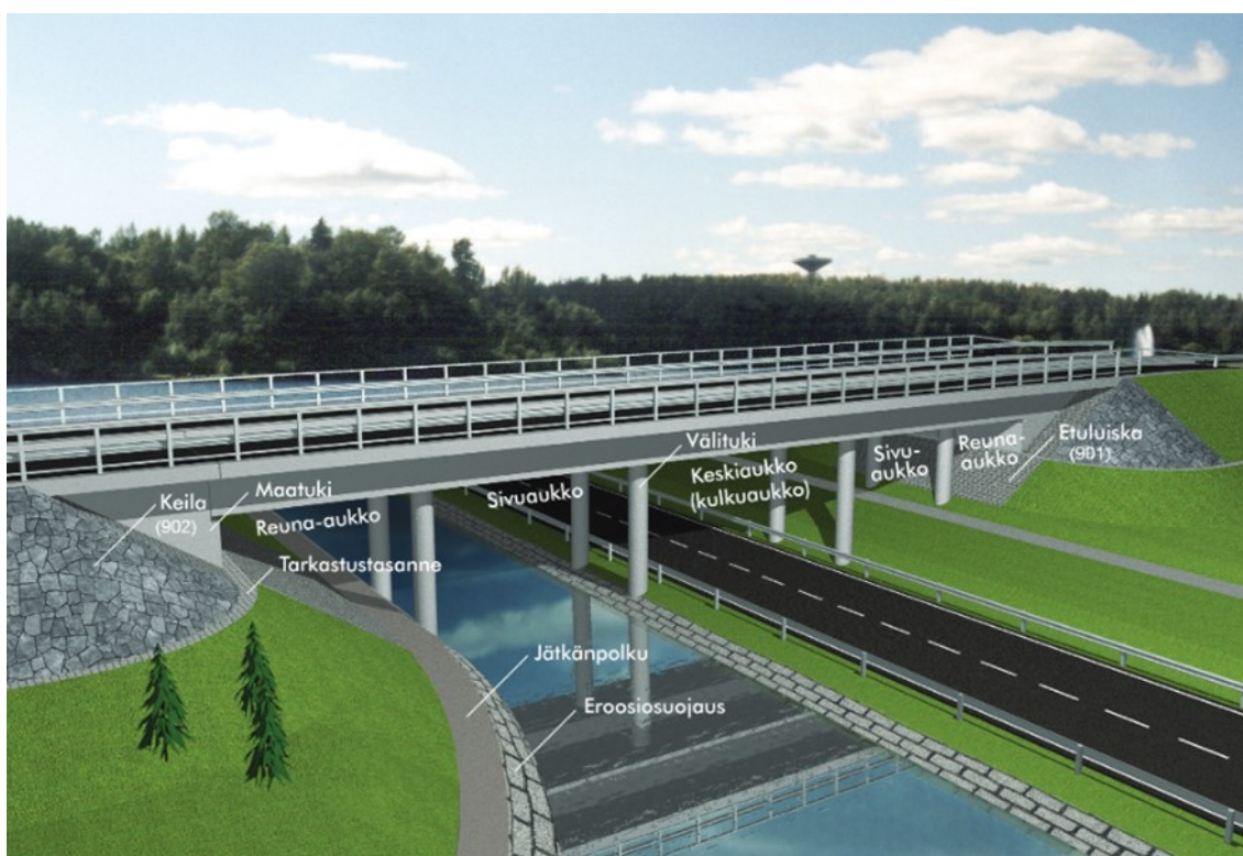
KUVIO 6. Sillan alusrakenteet ja siltapaikan rakenteet (Liikennevirasto 2013)
