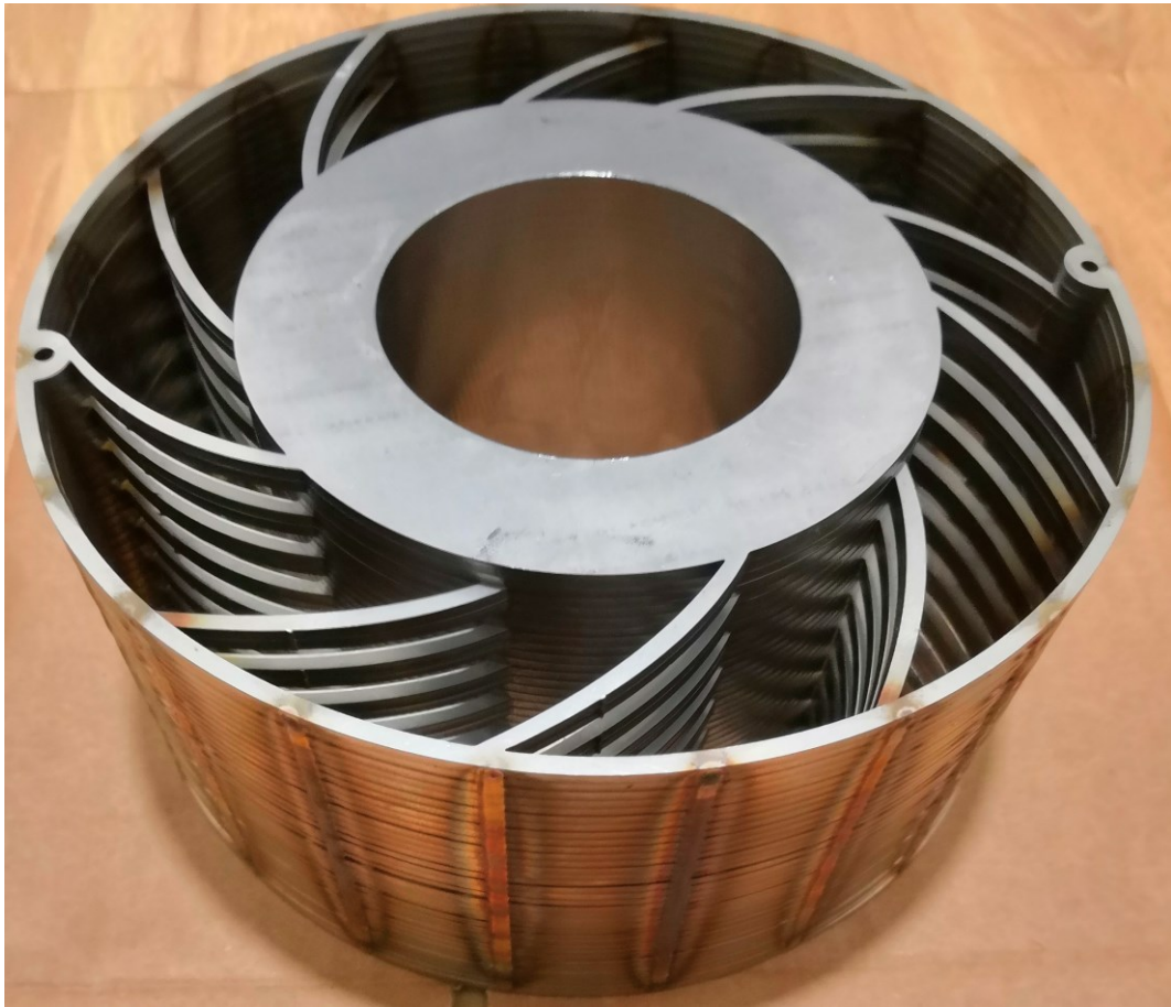
Kuva 12. Valmis hitsattu rengaspakka, kun puolat ovat vinossa.
