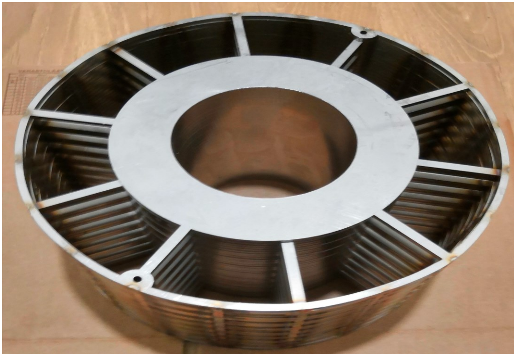
Kuva 11. Valmis hitsattu rengaspakka, kun puolat ovat suorassa.
