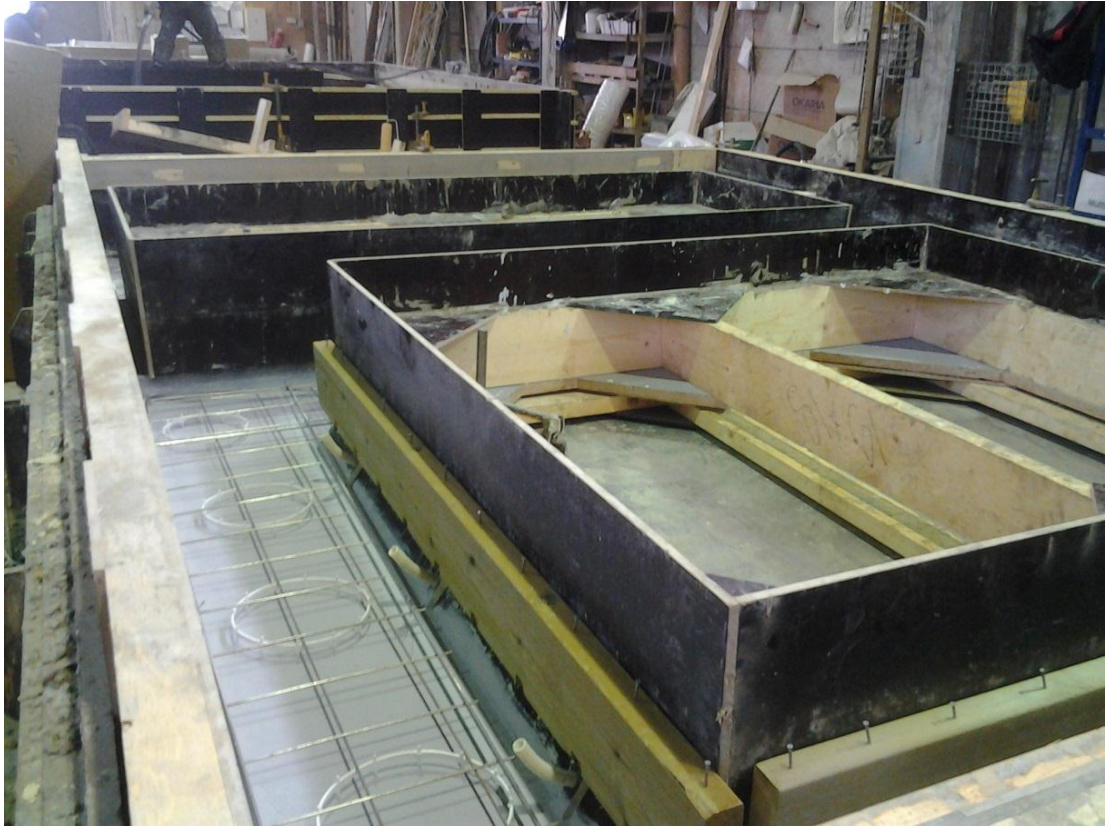
Kuva 7. Elementtien monimutkaisuus lisää valmistukseen kuluvaan aikaan ja muotti materiaalien kulutusta.
