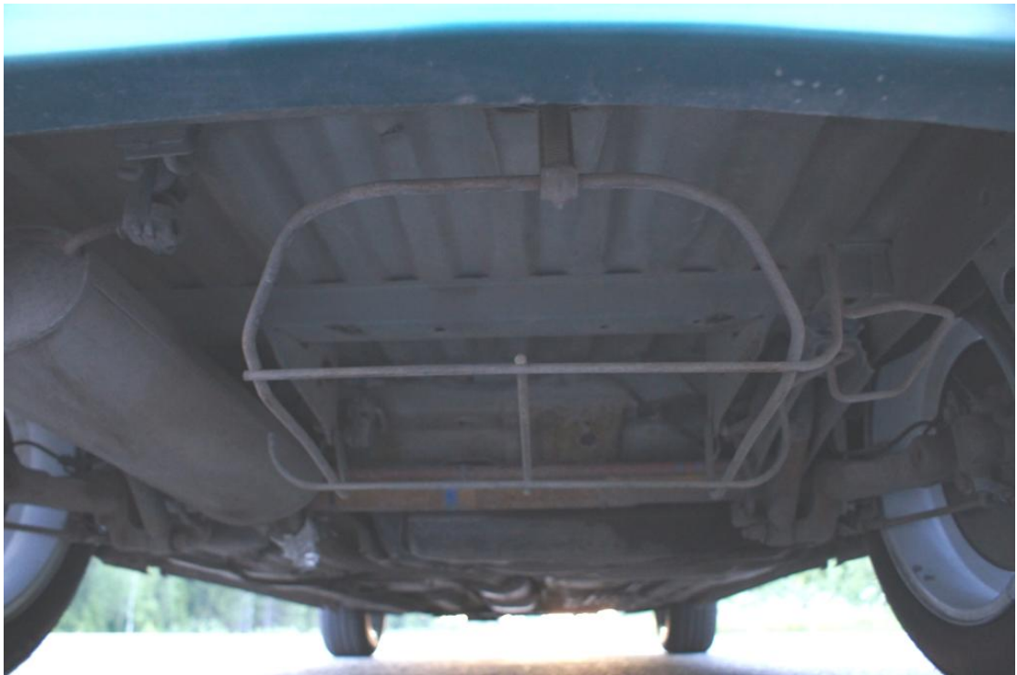
KUVA 12. Tyhjä vararengas häkki auton pohjassa
