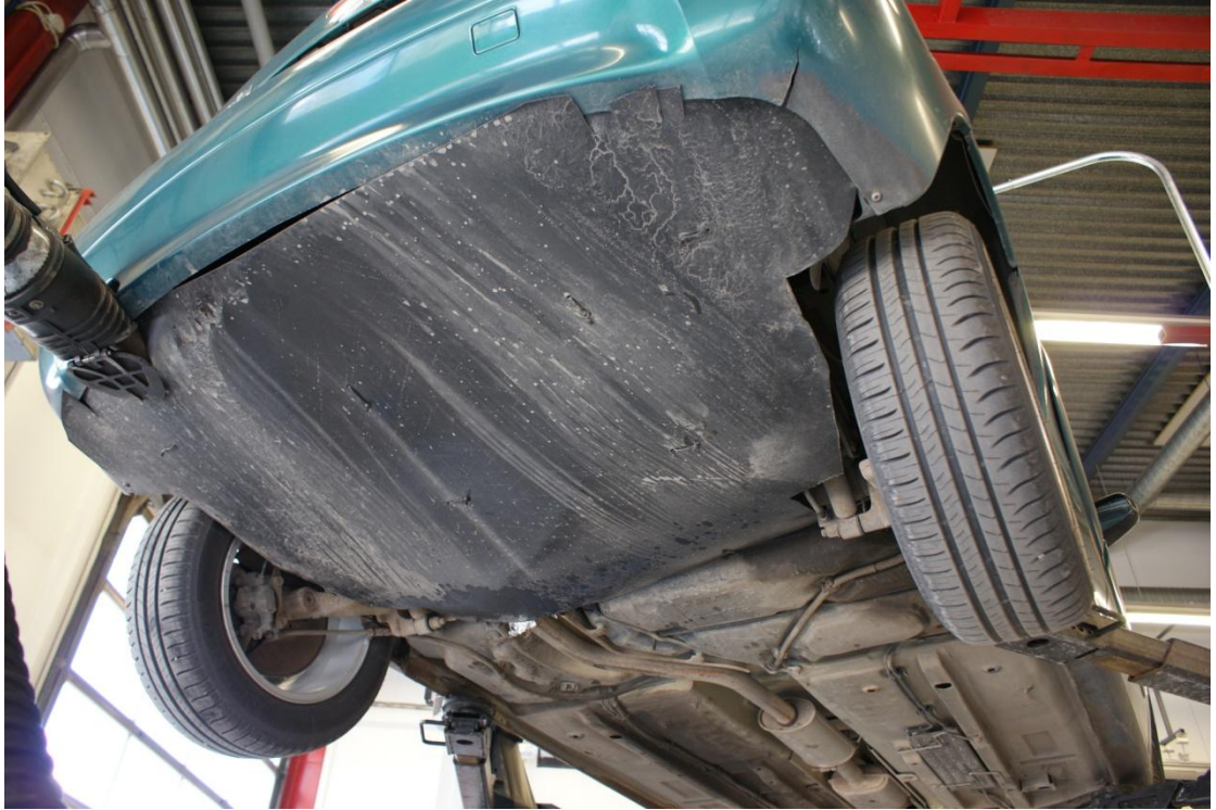
KUVA 14. Kohdeauton alustan muovitukset
