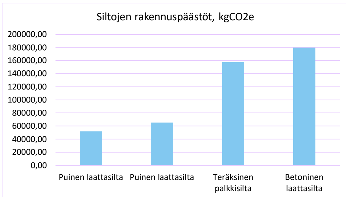
KUVIO 22. Siltojen rakennusmateriaaleista ja rakentamisesta aiheutuneet päästöt siltatyypeittäin.
