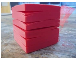
Kuva 7. Esimerkki tulosteesta, jossa on ilmennyt äärimmäistä kerrosten välistä delaminoitumista [5 Tips to Avoid Layer Delamination in 3D Printing 2021].
