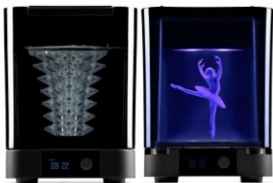
Kuva 8. Formlabsin resini-tulosteiden pesulaite ja loppukovetin [Form Wash + Form Cure 2021].
