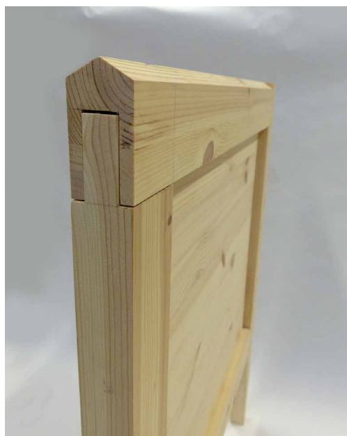
Bild 24. Snabba tester på sidoskivans placering. Dessa resulterade i insikten av att ifall man lämnar en kant (bilden till höger) påminner det mycket om traditionella soffor och därmed upplevde jag versionen till vänster, med de jämna kanterna, modernare. Konstruktionen syns även om man inte lämnar en kant tack vare furuns starka ådring.
