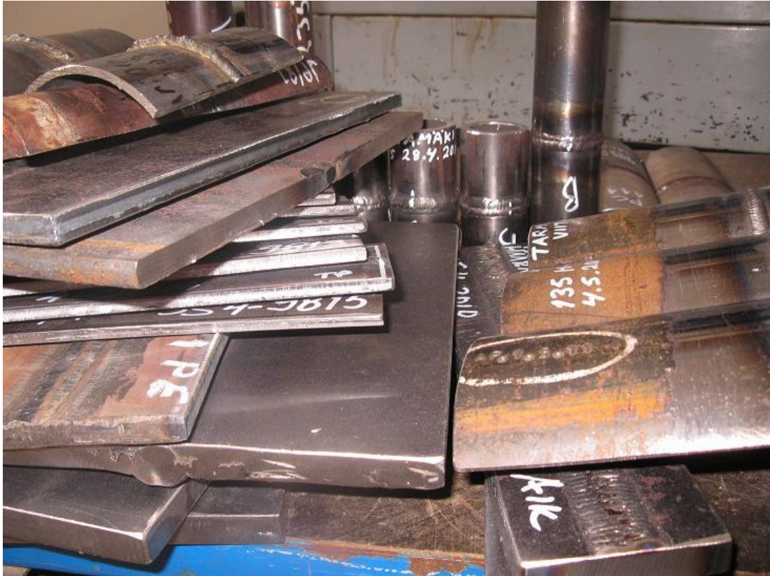
Kuva 15. Hitsattuja koekappaleita. (Insinööritoimisto Laatur testi Oy:n www-sivut)
