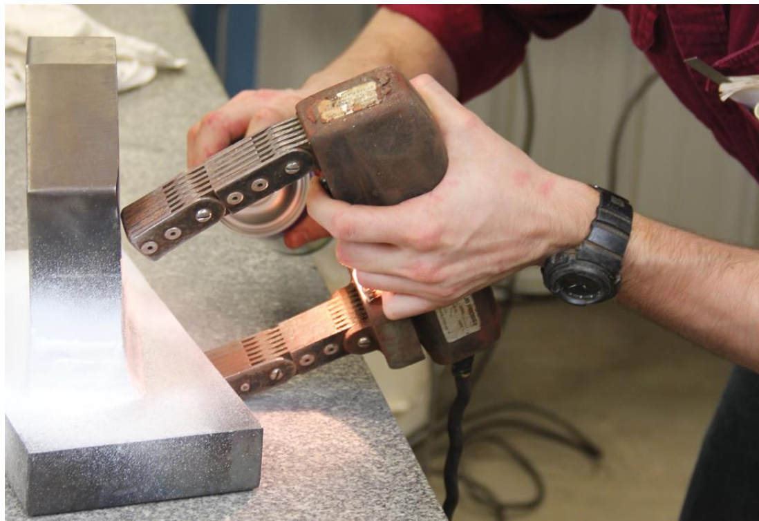
Kuva 10. Magneettijauhetarkastus. (Hutchinson Manufacturing Inc:n www-sivut)
