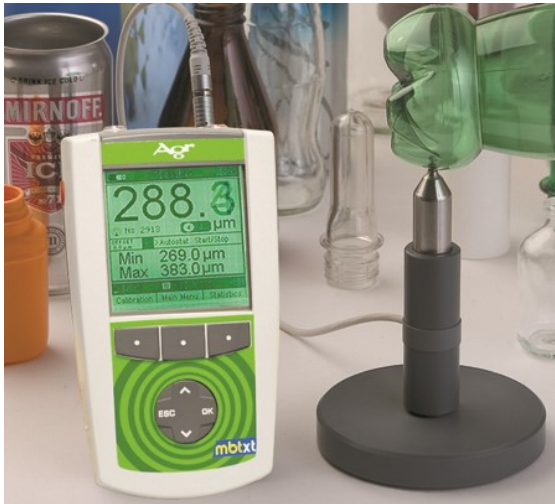
Kuva 14. Agr MBTtxt -paksuudenmittauslaite [45].
