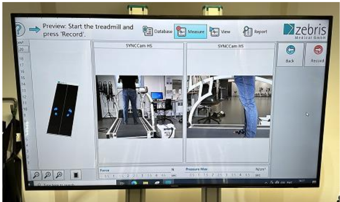
Kuva 7. Juoksumaton reaaliaikainen painejakauma ja videokameroiden näkymä henkilön seistessä hihnalla.
