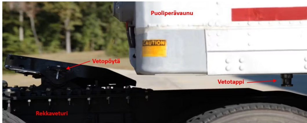
KUVA 4. Puoliperävaunun kytkentä vetotapilla vetöpöytään (muokattu Fleet Maintenance 2016).
