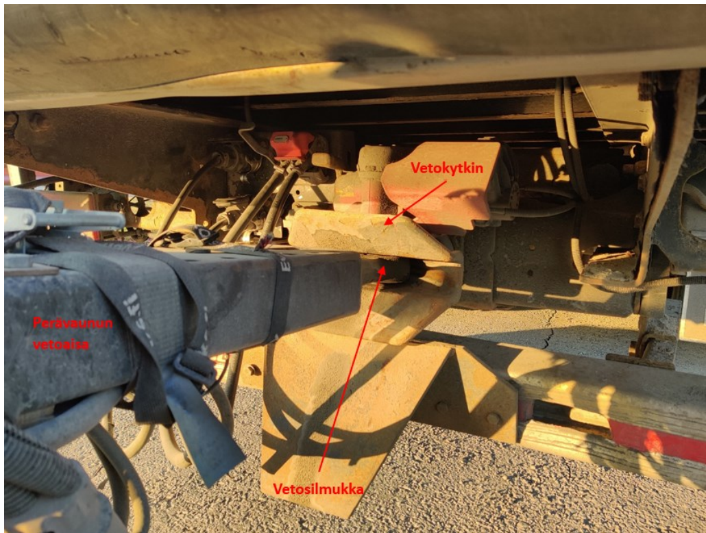
KUVA 3. Perävaunun kytkentä vetosilmukalla vetokytkimeen
