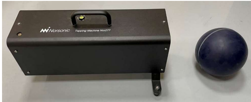
Kuva 6. Tutkimuksessa käytetyt standardoidut askeläänilähteet olivat a) askeläänikoje ja b) kumipallo.
