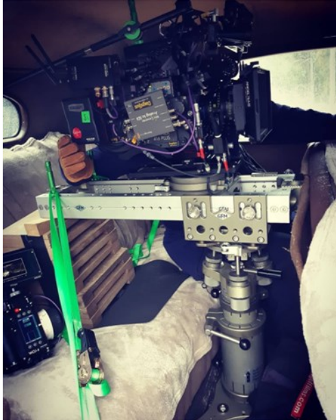
KUVA 16. Key grip Niskan tekemä slider-rigi auton takapenkille (Niska 2020).
