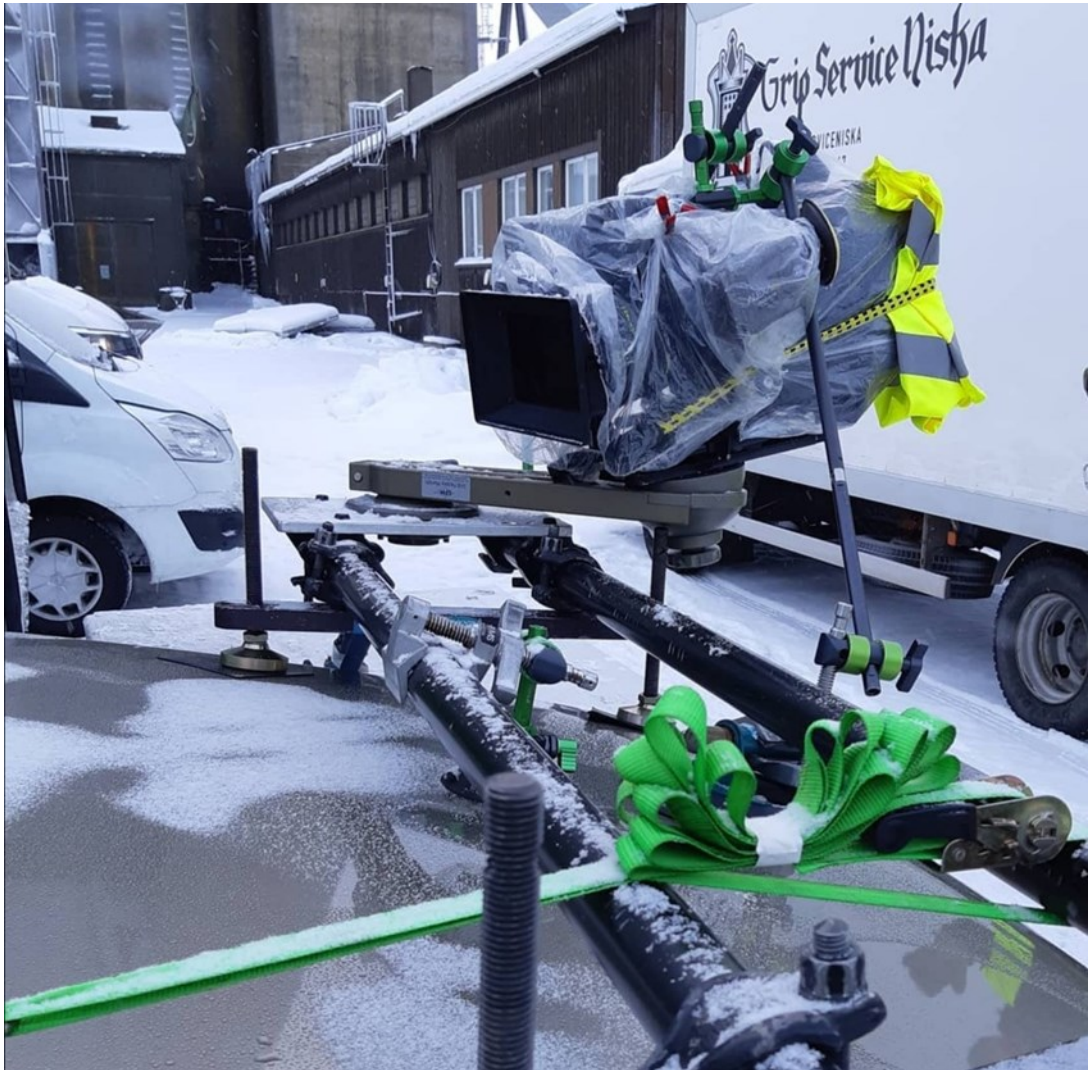
KUVA 13. Key grip Niskan tekemä konepeltirigaus (Niska 2019).
