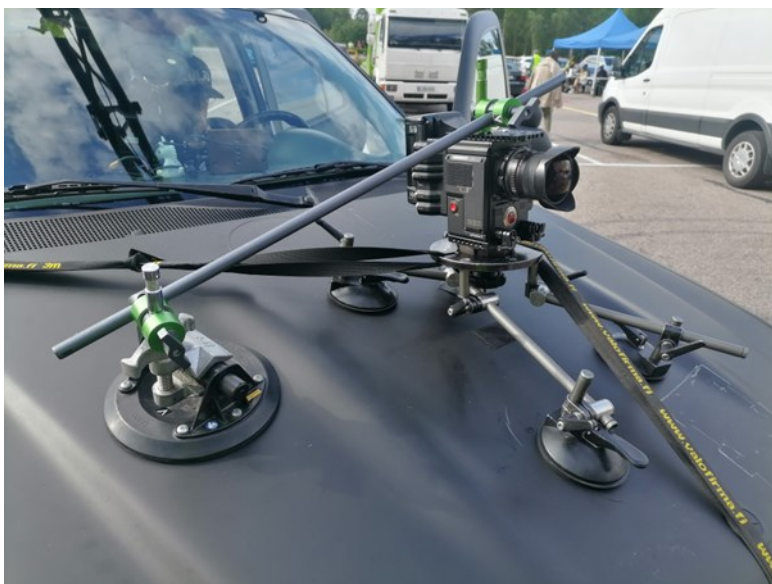
KUVA 5. Multi mount rigattuna auton konepellille (Vähärautio 2022).
