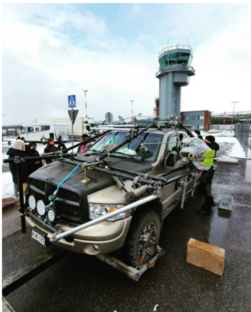
KUVA 14. Key grip Niskan tekemä autorigi (Niska 2021).
