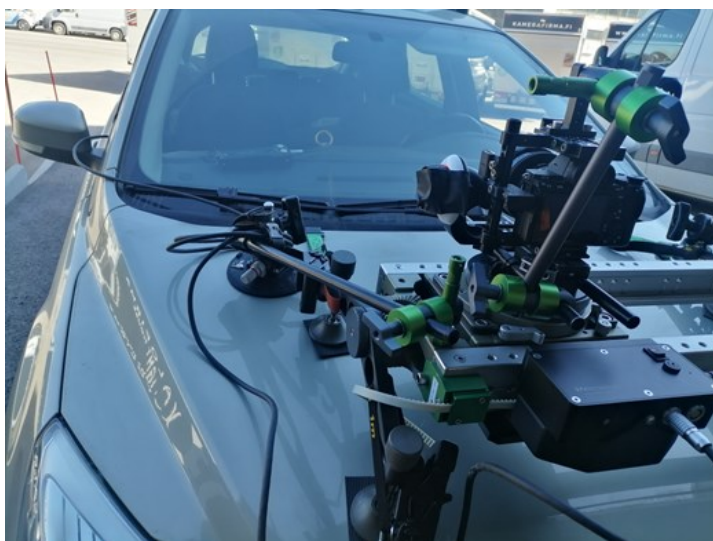
KUVA 21. GFM:n slideri moottorilla konepellillä (Vähärautio 2023).
