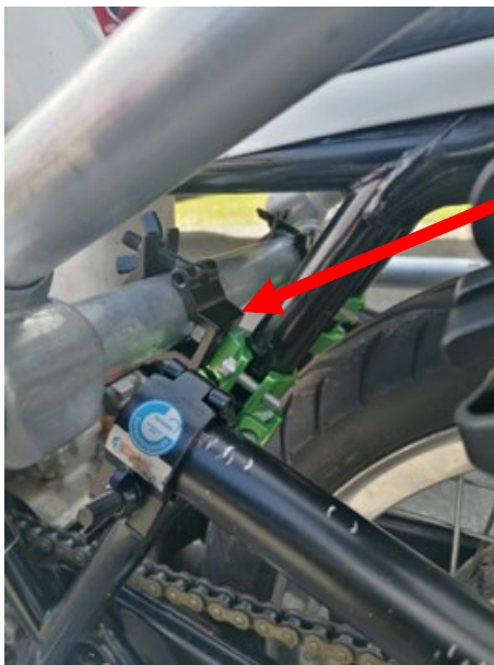
KUVA 17. Kahdesta eri clampista yhdistetty clamppi moottoripyörärigeihin (Vähärautio 2022).
