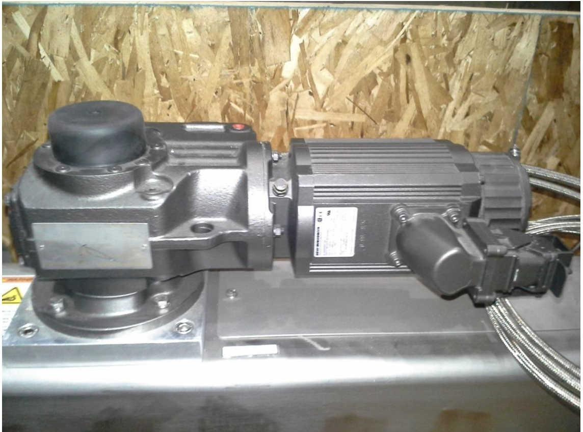
KUVA 13. Vesileikkauksen reunaleikkauksen servomoottori ja kulmavaihte
