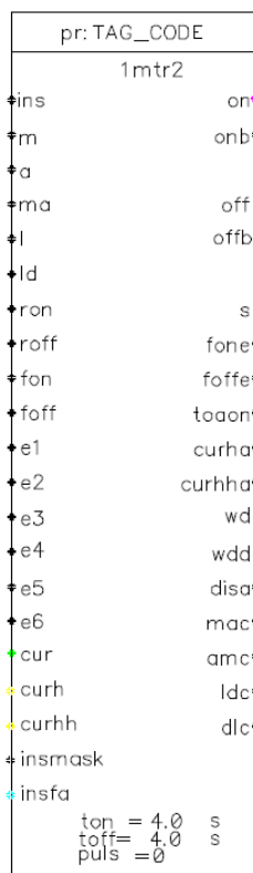
KUVA 4. Esimerkkikuva mtr2-toimilohkon piirrosmerkistä (Lähde: Metso DNA Manuals collection 2011 FI: Toimilohkot sivu 422)
