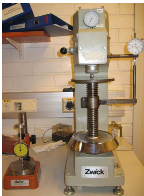
Kuva 18 Oikealla laite, jolla näytteeseen tehdään painuma ja vasemmalla paksuusmittari
