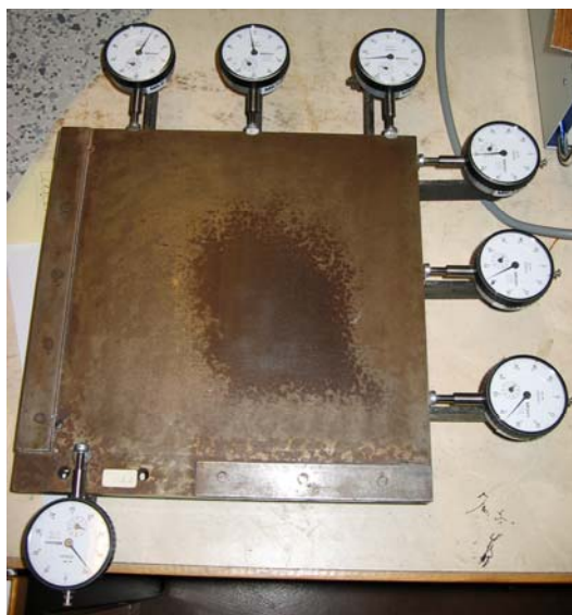
Kuva 17 Laboratorion mittauslaite, ns. jigi, dimensiomuutosten mittaamiseen
