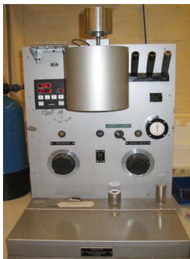
Kuva 14 Laboratorion sulaindeksin mittauslaite
