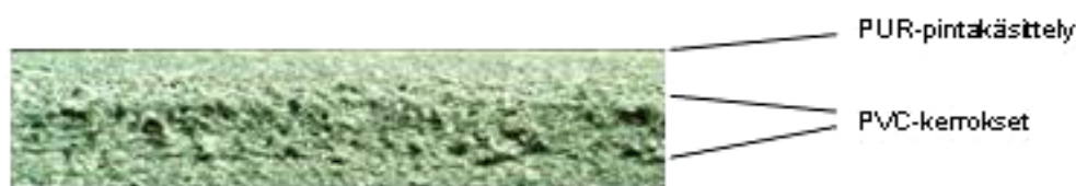
Kuva 1 Homogeenisen PVC-lattianpäällysteen poikkileikkaus
