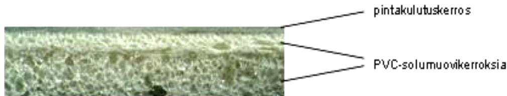
Kuva 3 Heterogeenisen joustovinyylimaton poikkileikkaus
