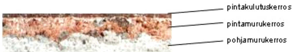
Kuva 2 Monikerroksisen, PVC-vapaan, lattianpäällysteen poikkileikkaus
