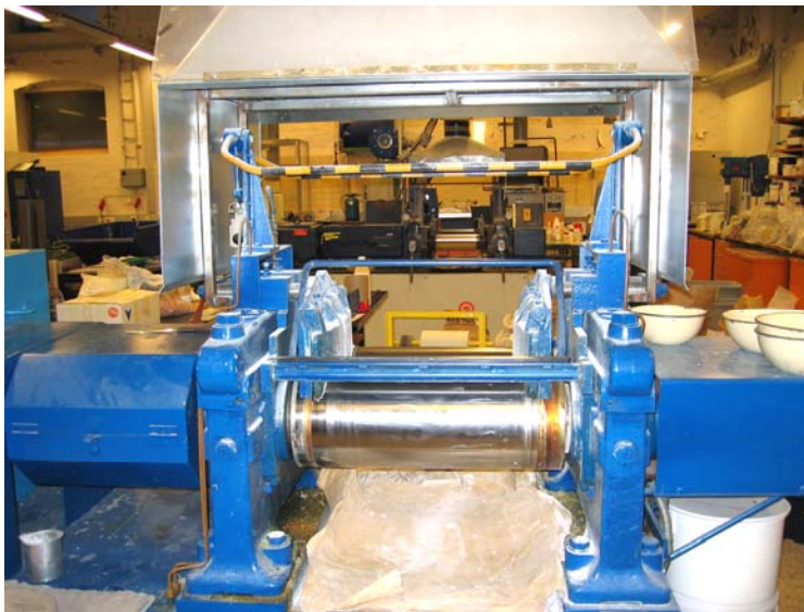
Kuva 13 Laboratorion Troester-merkkinen sekoitusvalssi
