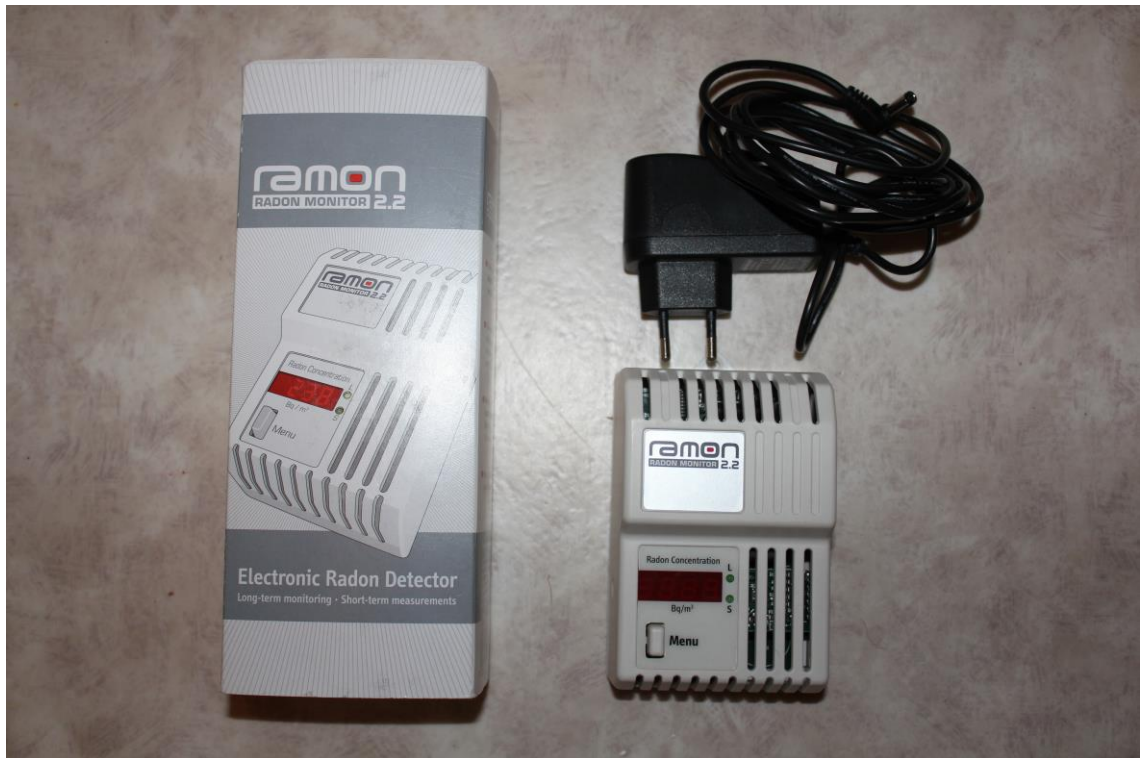
Kuva 11. Radonmittaukseen käytetty radonmittari Ramon radon monitor 2.2.
