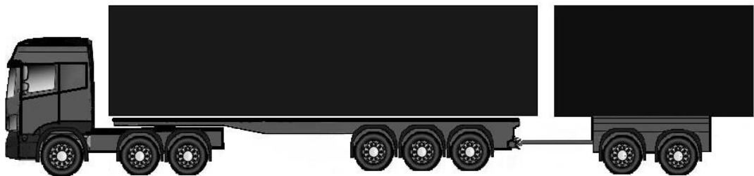
KUVA 24. Puoliperävaunuyhdistelmä, jossa on perässä keskiakseliperävaunu (kansankielellä vasikka)
