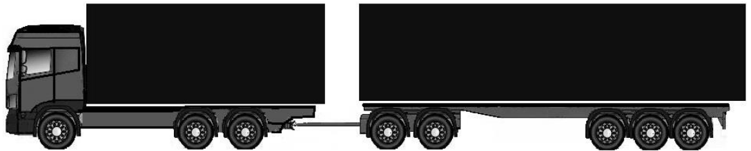
KUVA 3. Apuvaunun päälle kytketään puoliperävaunu ja saadaan muodostettua varsinainen perävaunuyhdistelmä. Kytkemisessä tai liikenteessä ei tule ongelmia esimerkiksi mittojen tai ajettavuuden suhteen, koska liitettävyyden on mahdollista juurikin moduulimittojen vuoksi.
