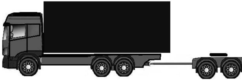
KUVA 2. Suomalainen kuljetusyrittäjä noutaa puoliperävaunun satamasta omantyyppisellään kalustolla vaivattomasti sekä toimittaa rahdin määränpäähän. Tässä tapauksessa kyseessä on kolmeakselinen moduulimitoissa oleva kontti-auto, jossa on perässä apuvaunu eli niin sanottu dolly.
