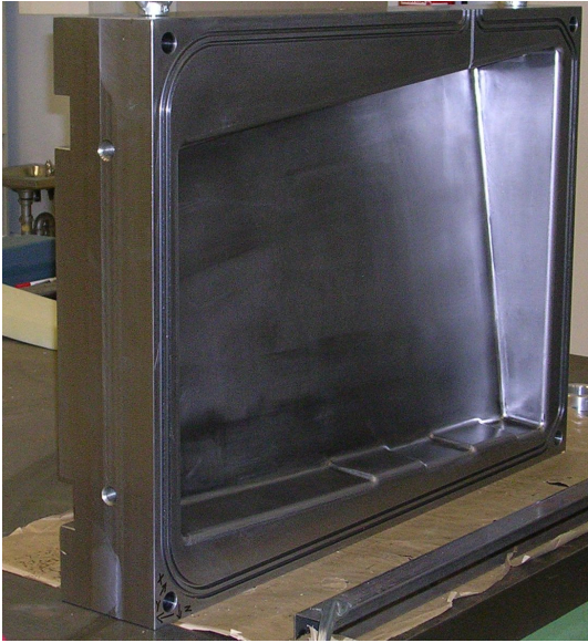
Kuva 2.4 Suunnitteluvaiheen C-osuuden RTM muotti (mitat 1000 x 700 x 160mm) /2/
