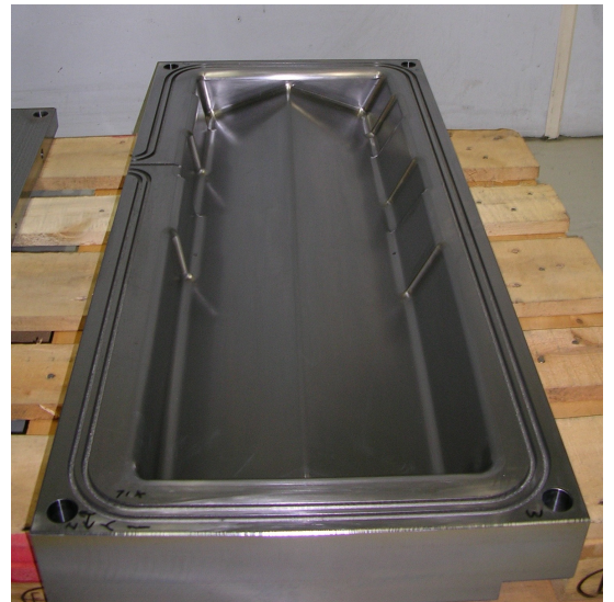
Kuva 2.5 Suunnitteluvaiheen irtolaippamuotti (mitat 1000 x 550 x 110) /2/
