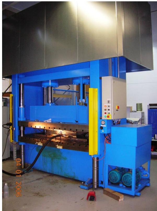
Kuva 3.1 Prässi ennen modifikaatiota, pumput ja sähkökaappi oikeassa päädyssä..
