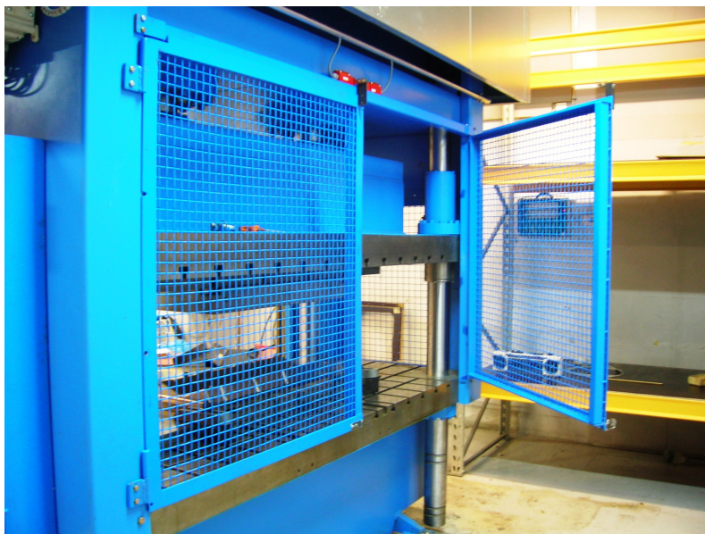
Kuva 3.2 Prässi takaosa, modifikaation jälkeiset kaksiosaiset ovet ja rajakytkimet
