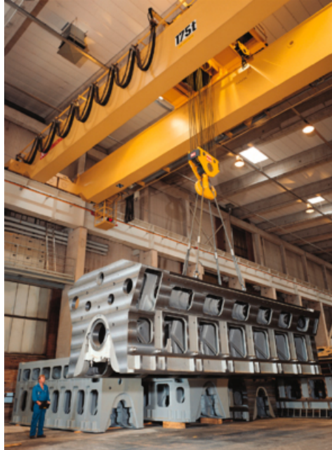
Kuva 4: KCI Konecranes Oyj:n valmistama prosessinosturi, jossa sm-nostinvaunu /7/.
