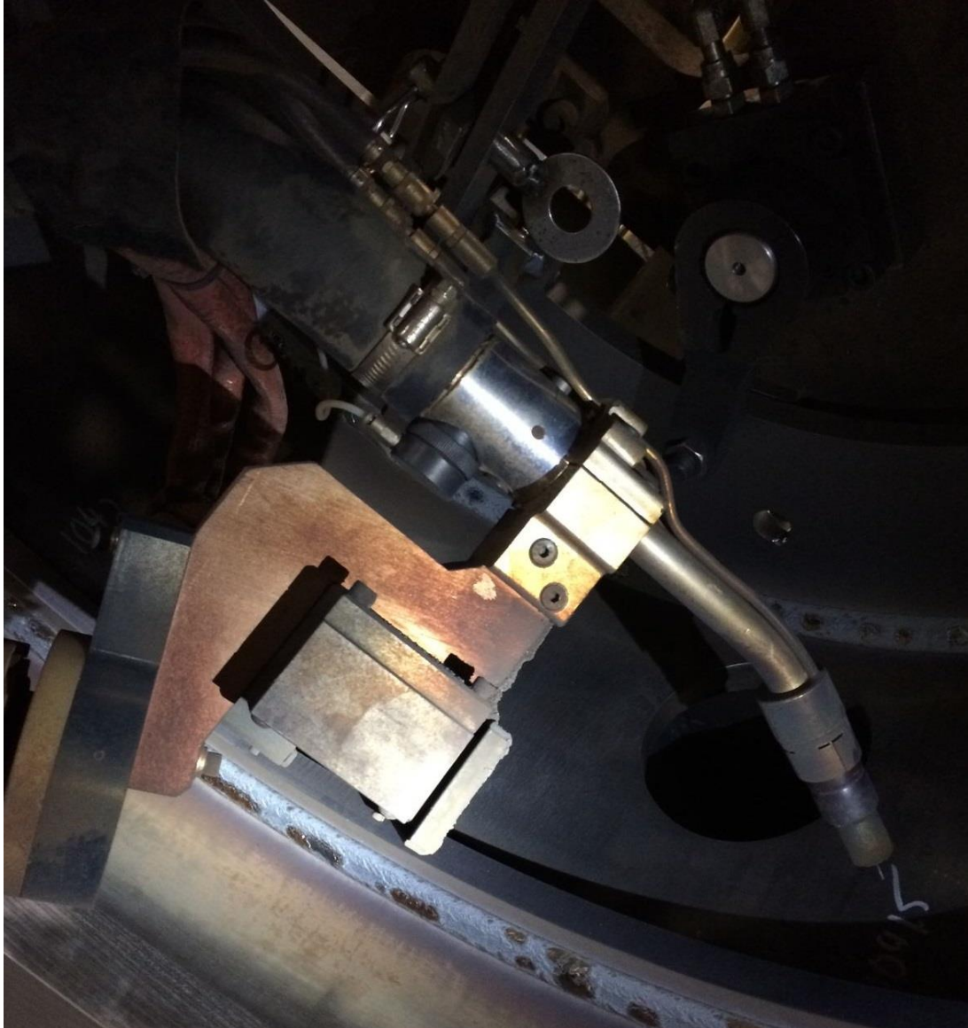
Kuva 16. Keyence IL-300 anturi asennettuna Fanuc- robotissa. (Butler 2015.)
