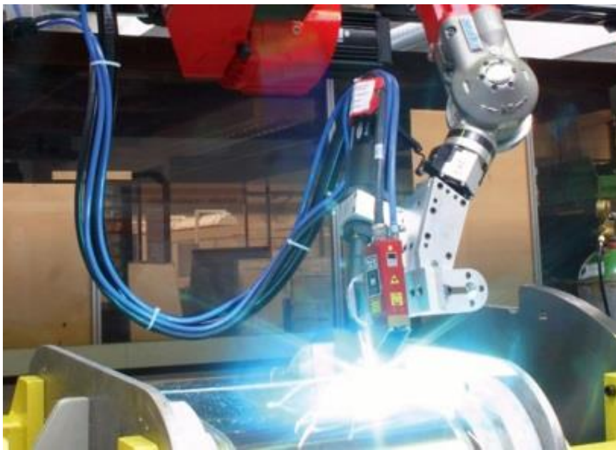
Kuva 22. Servo-Robot Inc. Power-Cam haku- ja seuranta-anturi. (Servo-Robot Inc 2014.)
