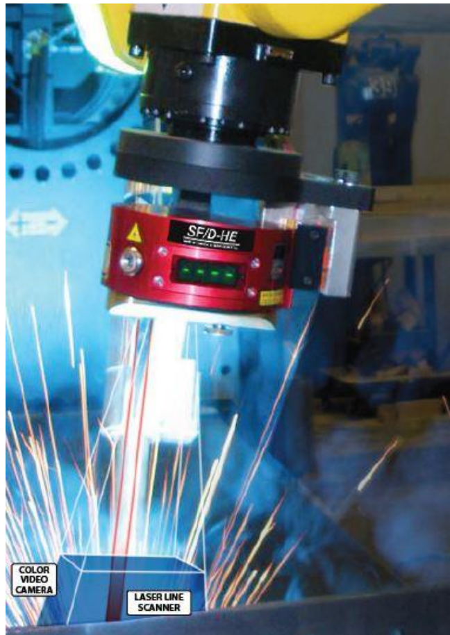
Kuva 18. Servo-Robot Inc. Robo-Find –railonhakuanturi. (Servo-Robot Inc 2014.)
