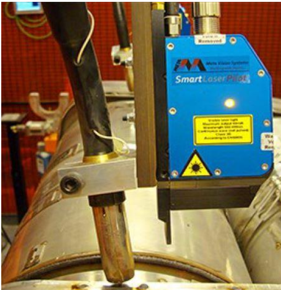
Kuva 21. Meta Vision System Smar Laser Pilot haku- ja seuranta-anturi. (Karjalainen 2015.)
