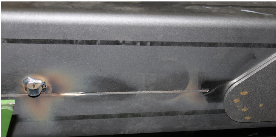
Kuva 9. Hakuun ja seurantaan soveltumaton hitsausliitos sen kapeuden vuoksi.
